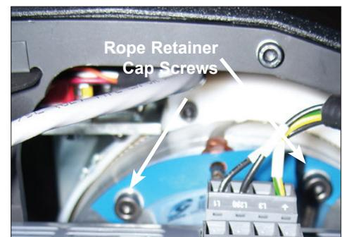
**Fig. T.** Rimuovere le due viti a testa esagonale M6 e far scorrere il fermo dalla corda verso di voi. La configurazione può variare a seconda della capacità.
