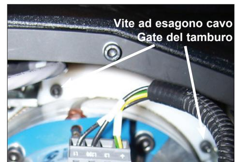
**Fig. S.** Rimuovere quattro viti a testa esagonale M6 dai gate del tamburo.
