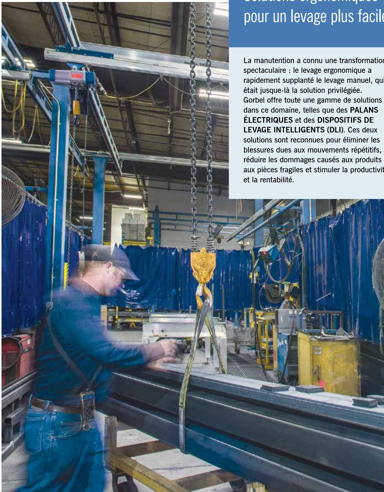
LES PALANS ÉLECTRIQUES constituent une excellente solution pour la plupart des applications de manutention standards.
