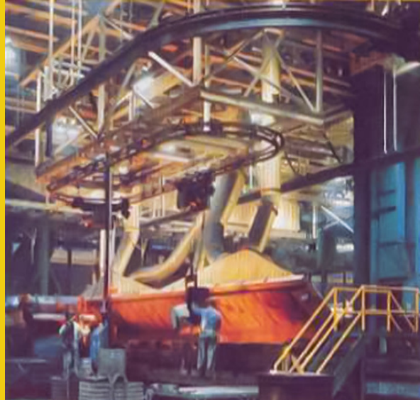
4 ЗАЛИВКА, ОСУЩЕСТВЛЯЕМАЯ С ОТДЕЛЬНО-ОСТОЯЩЕЙ КНОПочНОЙ СТАНЦИИ
