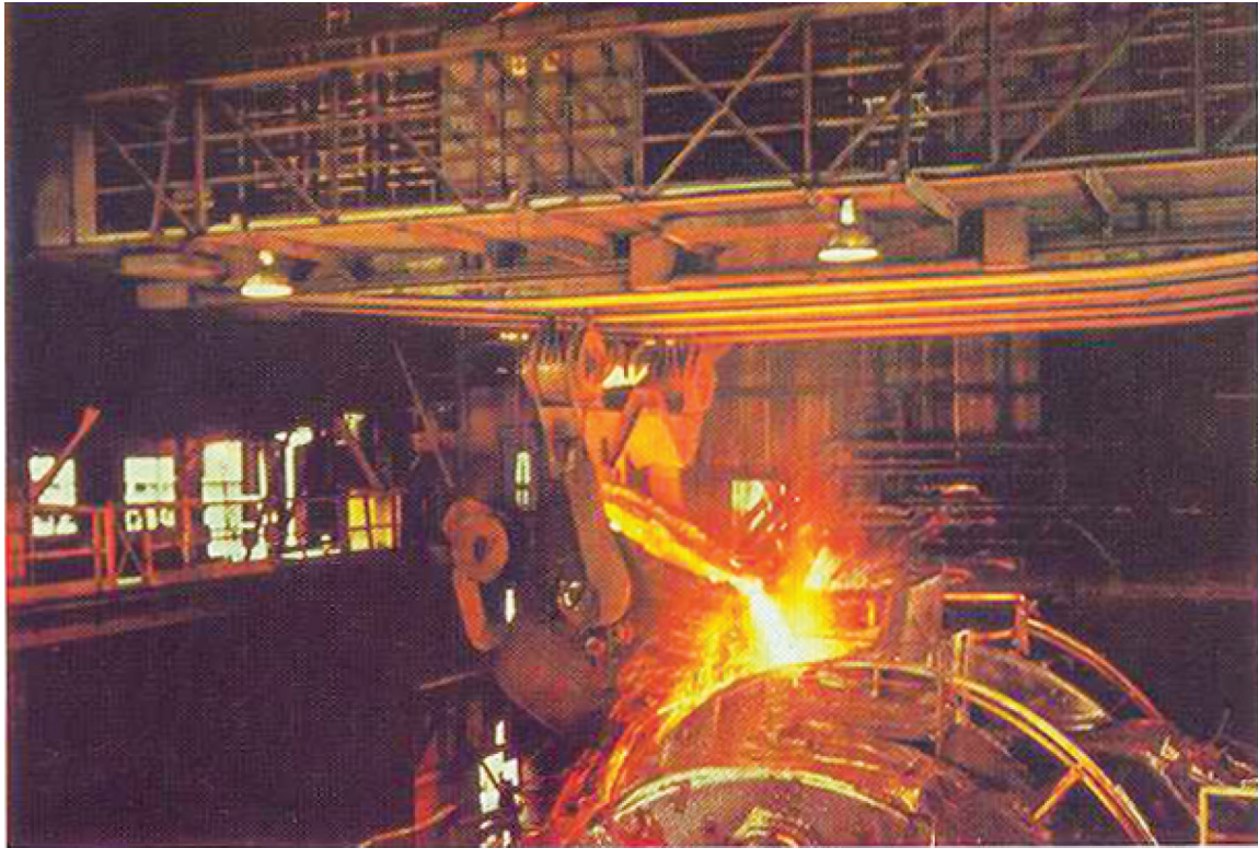
ПЕРЕЛИВ ЖИДКОГО МЕТАЛЛА В ПЕЧЬ ВЫДЕРЖКИ
