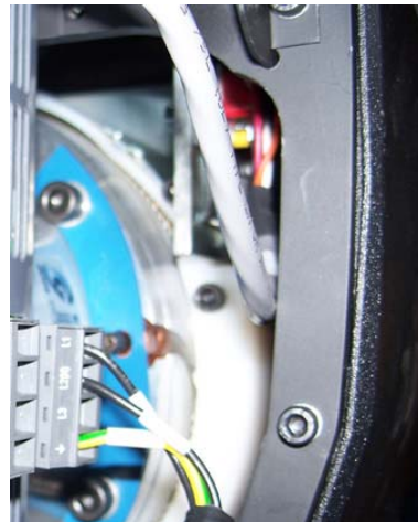
Diagrama de S. Retire los dos tornillos de M8 de cabeza y retención deslice del fin de la cuerda hacia usted.
