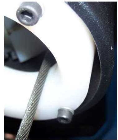
Diagrama de M. Inserte un destornillador entre el anillo de vestir de blanco y la emisión del actuador donde sale el cable del actuador.
