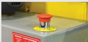
**Frenos de Emergencia** detienen todo movimiento de la máquina.
