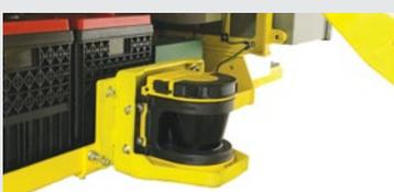
**Escáner de Área, Frontal y Trasero:** detectan personas y objetos, reducen la velocidad de la máquina y evitan obstáculos.
