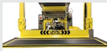
**Borde de Detección Frontal** (en la plataforma del operador), detiene el movimiento hacia adelante cuando está activado.
