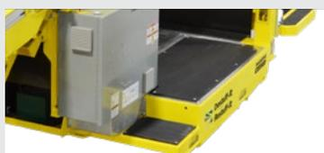
**Tapetes de Seguridad con Detección de Presión** al ser activados, detienen el movimiento de las bandas.
