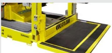
**Tapete de Detección del Operador** debe ser activado para el funcionamiento de la máquina.
